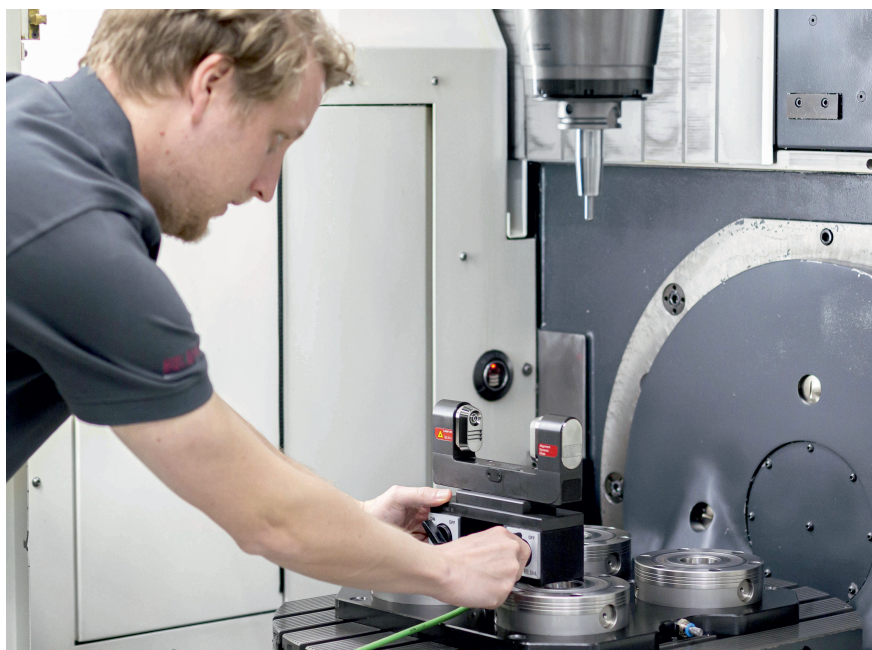
Bild 3. Teil des Systems ist das aus den Bearbeitungszentren bekannte Lasermesssystem LC50-DIGILOG. Es wird ganz einfach mittels Magnethalter auf dem Bearbeitungstisch der Maschine befestigt.
