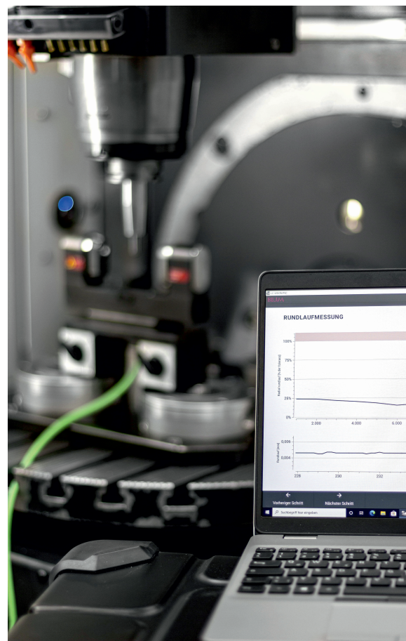
Bild 2. kptec nutzt zur mobilen Spindelüberwachung Portable SpindleControl (PSC) von BLUM, ein hochpräzises, tragbares System zur flexiblen Prüfung und Überwachung von Motorspindeln in Werkzeugmaschinen.
